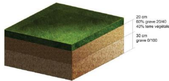
La proportion de terre végétale et de gravé est à ajuster en fonction de la portance du sous-sol.
